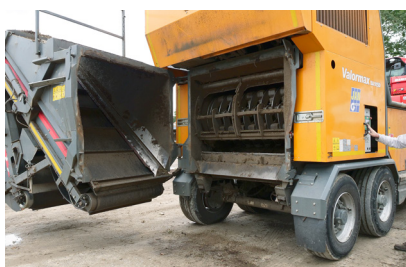
Monté sur charnière, le tapis d'éjection du Valormax BA915D peut pivoter à 90° afin de dégager l'espace devant le rotor.
