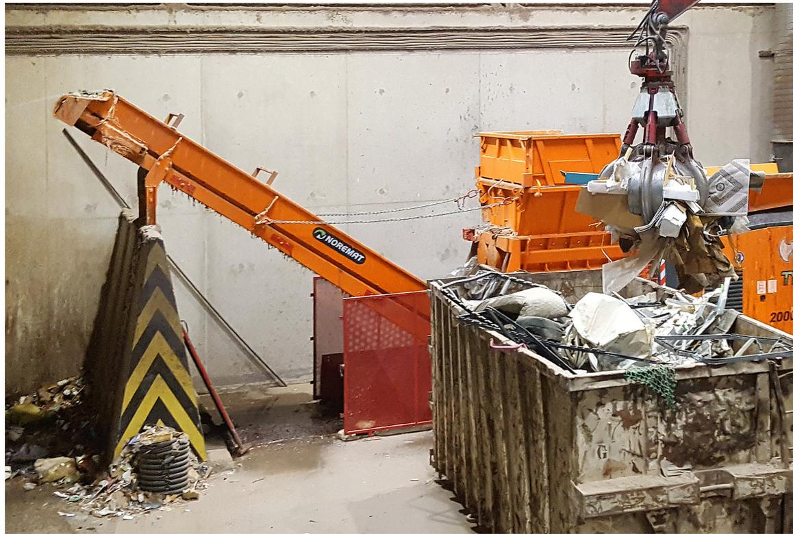
Le Tyron, avec une trémie de grande capacité, est en mesure de broyer 37 tonnes par heure.
