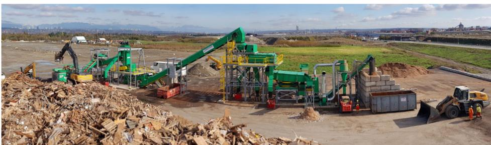
Ligne stationnaire de traitement des déchets comprenant le broyeur Tyron avec : affinage, criblage, séparation des ferreux et non ferreux
