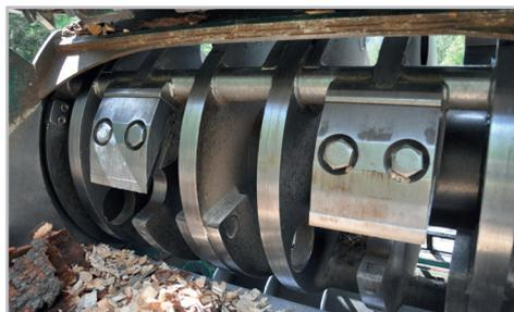
Rotor D1 conçu pour la production de plaquettes de très grand calibre
